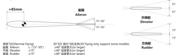
部分特殊机型会有V型尾翼,襟翼,前缘机翼或舵面很小等,可以以常规飞行的角度作为参考,在您不确认且没有有经验人员指导的情况下,我们建议您先以小角度试飞以确认您的设置是否正确。
