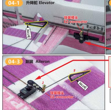
在副翼,升降舵,转向舵上预留槽对应位置安装舵角,位置参考以上三张图,用胶水粘合。
