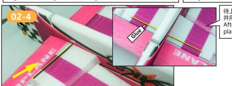
│ 待上一步胶水干后,在机翼预留的切口内嵌入碳片, │ 并用泡沫胶粘合固定。
